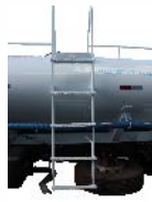
Escada lateral ou traseira com degraus antiderrapante
